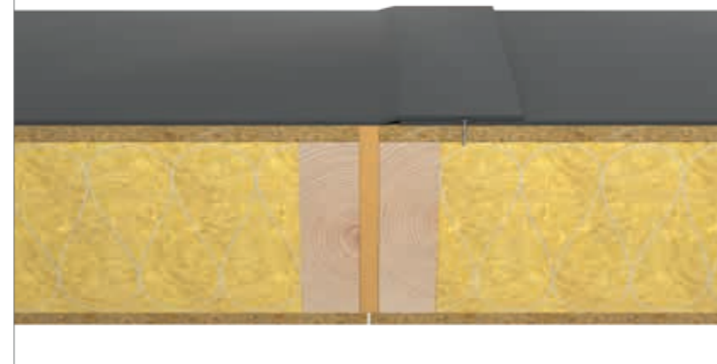
Styk montażowy pomiędzy elementami dachowymi
